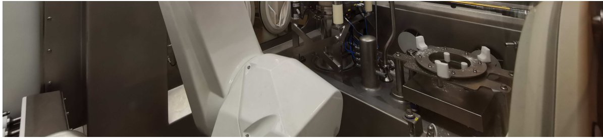
Abbildung 5 Roboter zur Handhabung von hochaktiven aseptischen Wirkstoffen in Aluminium-Kannen (Quelle: SKAN AG)
